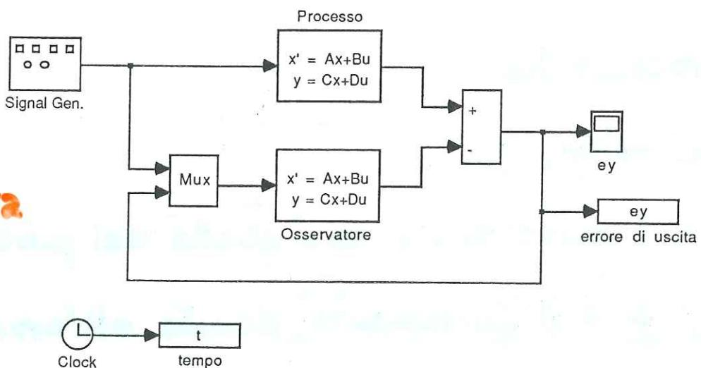
simulazioni effettuate con RK23,  $t_{\text{samp}} = 0.01$
