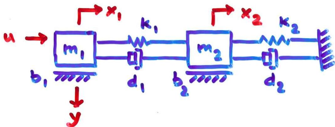
Schematizzazione del controllo di posizione di un utensile in una macchina a controllo numerico
